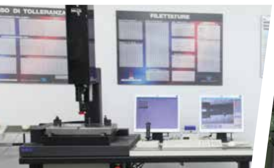
Macchina di misura MICRO-VU 3D CNC ottica serie QUIBIC
