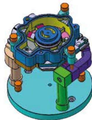
Piattamento per macchina di misura zeiss
