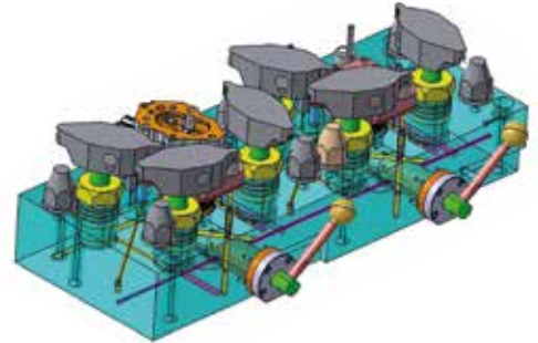
Pallet multiplo per centro di lavoro con posizionamento pezzo manuale e bloccaggio idraulico
