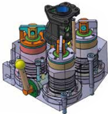
Torretta per centro di lavoro con posizionamento pezzo in manuale e bloccaggio idraulico
