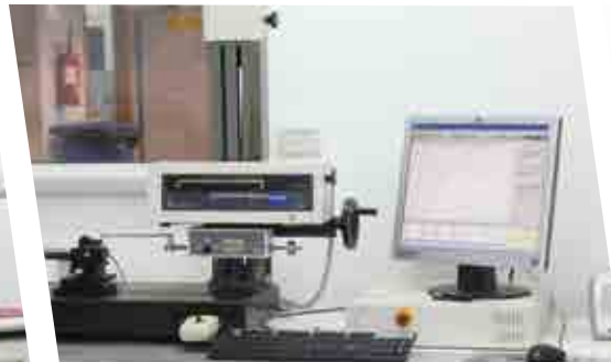
Rauheitsmessgerät/Konturmessgerät ZEISS TSK Surfcom 1800 D-23-N CNC-gesteuerte
