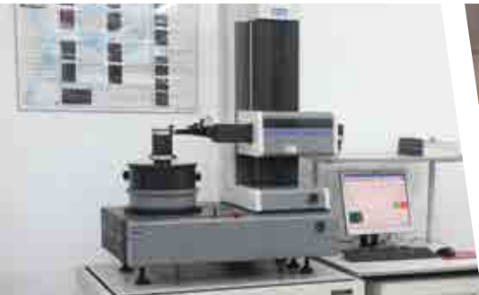
ZEISS TSK Rondcom 60 CNC gesteuerte Universalformtester für die Auswertung von Rundheit
