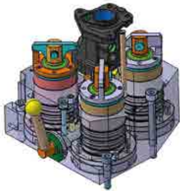
Turm für Bearbeitungszentrum mit manueller Werkstückpositionierung und hydraulischer Klemmung
