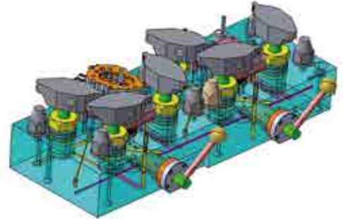
Mehrfachpaletten für Bearbeitungszentrum mit manueller Werkstückpositionierung und hydraulischer Klemmung
