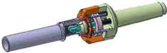
Reitstock mit Phasing-/Ziehsystem auf innengerilltem Profil mittels Expander
